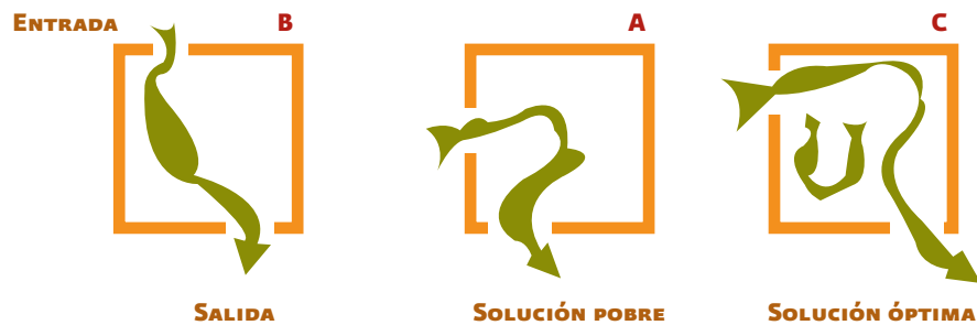
FIGURA 15.1 Esquema de ventilación cruzada
